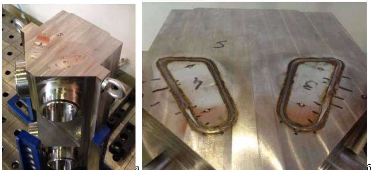
Рис. 2 Коллектор купола с прихваченными (а) и заваренными заглушками (б)
