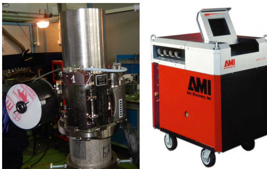
Рис. 4 Головка орбитальной сварки AMI Model 81 и программируемый многофункциональный сварочный источник Model 415
