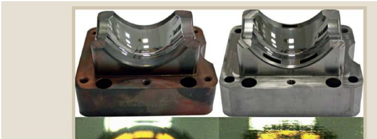
Bild 3. Vergleich des bei Kugler auf der Micromaster diamantbearbeiteten Bauteils (links) mit dem vom Kunden bestellten Vergleichsteil (rechts). Der Farbunterschied der beiden Werkstücke rührt vornehmlich von der geringfügig unterschiedlichen Wärmebehandlung der Teile her
